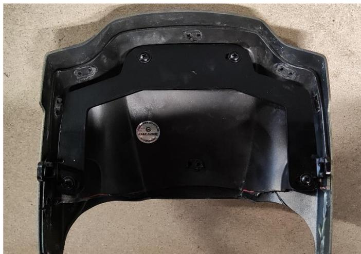
3. Der Maskenhalter wird nun seitlich mit den Linsenkopfschrauben M6x12 befestigt. Diese werden direkt in den Haltebügel eingeschraubt
