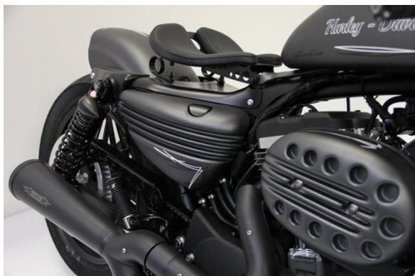
Abb. 2 – montierter Seitendeckel
