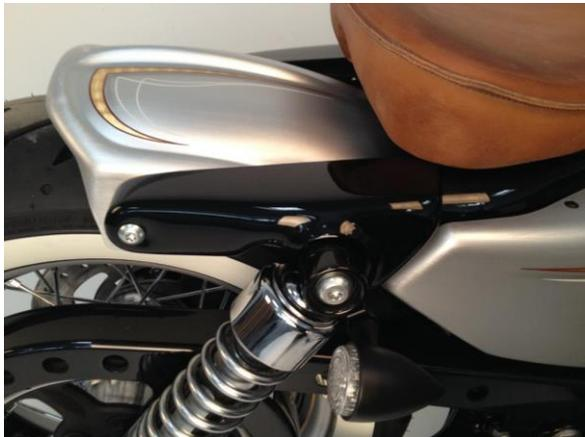
Abb. 1 – montierte Fender Struts
