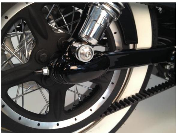
Abb. 1 – montierte Achscover
