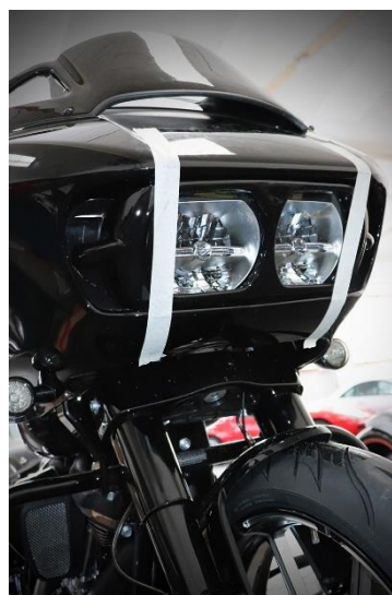
Abb. 1 & 2 – Anbringen Montagekleber sowie vorübergehende Befestigung!
