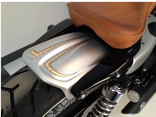
Abb. 1 – montierter Fender, Fender Struts und Blinker
