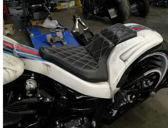
Abb.9 Montiertes 2-Sitzer Heck
