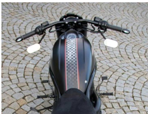
Abb. 1 – montiertes Airbox Cover mit verbautem Tacho
